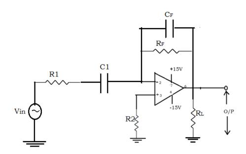
$R_F=1.5k\Omega$ ,  $R_2=1.5k\Omega$ ,  $R_1=82\Omega$ ,  $R_L=10k\Omega$ ,  $C_F=0.005\mu$ F,  $C_1=0.1\mu$ F,
